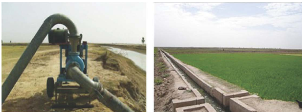
Photos Kadidia N. Bouaré (moto-pompe diesel et canaux répartiteurs)
